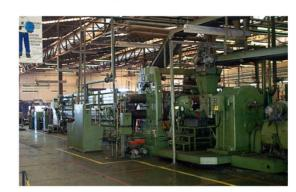
Lençóis à base de borracha sintética clorobutílica ou bromobutílica, extrudadas em equipamento *Roller-Head* sob alta pressão e calor, na espessura final desejada, em uma única passagem. Este processo é o mais avançado, resultando em produtos homogêneos, de alta qualidade e performance.
