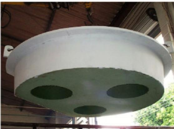
Deltas pré-fabricados, empregando concreto de ultra baixo teor de cimento, com alta refratariedade e excelente resistência mecânica, visando o aumento da vida útil do equipamento e conseqüente redução do consumo específico.
