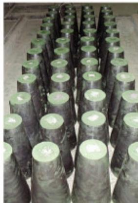
Peças pré-moldadas aluminosas, à base de concretos refratários de baixo teor ou ultra baixo teor de cimento, apresentando características de alta resistência à abrasão e/ou resistência mecânica, podendo operar até a temperatura limite de 1800°C.
